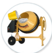
2. Adicione o agregado (brita) na betoneira ligada .
