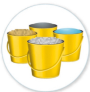
1. Faça uso de uma medida (balde) para dosar os componentes.
